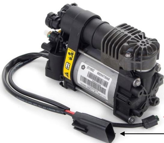
1. Ligue o conetor de alimentação do motor, inserindo-o no fundo e fixando-o com o gancho triangular situado na parte de trás.
